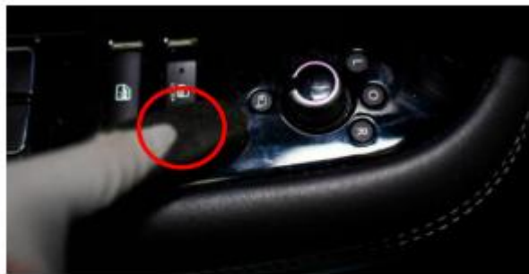
图 3-84 转动旋钮至外后视镜折叠按钮
