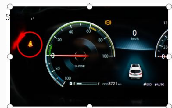
图 3-71·安全带未配，车辆静止状态下的指示灯点亮
