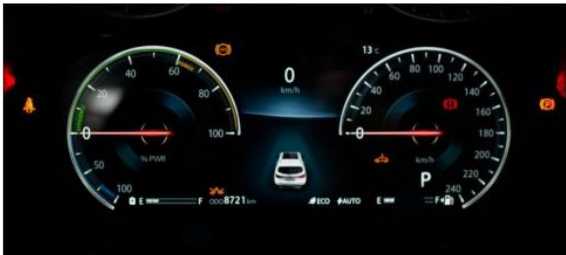
图 3-70·车辆上电仪表盘显示图
