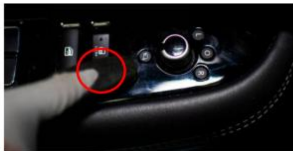
图 3-84·转动旋钮至外后视镜折叠按键
