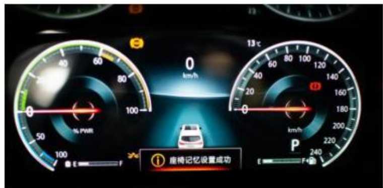
图 3-79·座椅位置存储成功后仪表显示图
